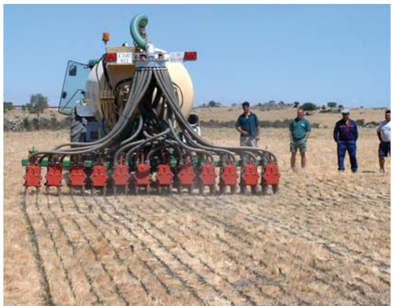
Figura 13. Sistema de inyección para la aplicación de purín al campo.
