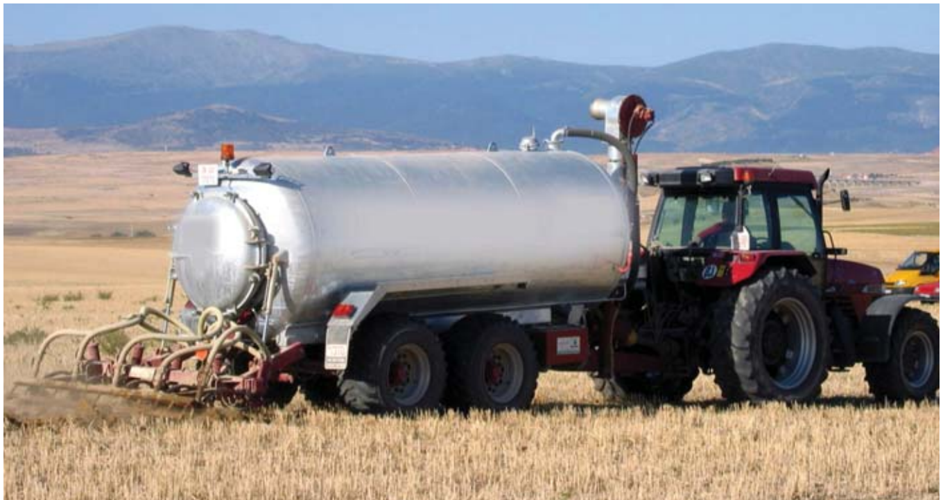
Figura 14. Sistema de discos para la aplicación de purín al campo.
