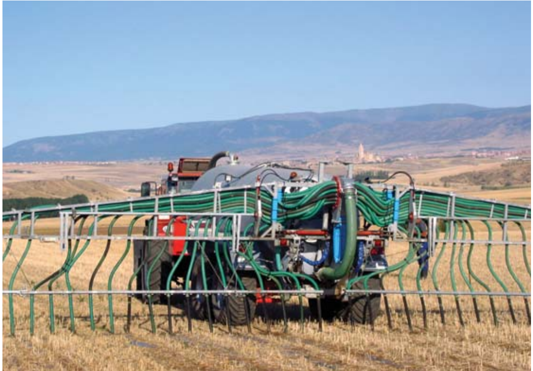
Figura 12. Sistema de bandas para la aplicación de purín al campo.
